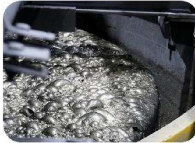
Анализ размера, формы, цветности, времени жизни, скорости пузырьков флотации для корректировки технологического процесса
