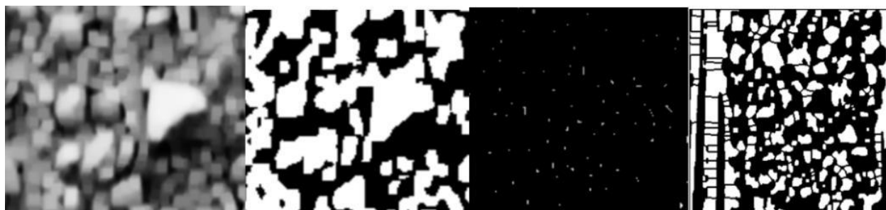
Рисунок 7.2 – Процесс расстановки маркеров и вычисление маски
