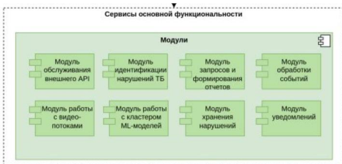
Рисунок 2.9 — Схема сервисов основной функциональности
