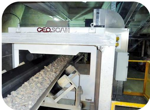
Анализ гранулометрического (анализ размера и поиск негарбарита, «глинистости», инородных тел и примесей) состава руды для корректировки режима работы дробилки
